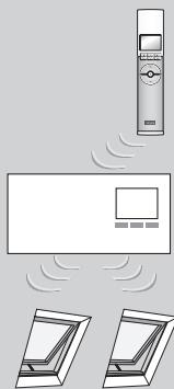
**Nota:** En un sistema pueden configurarse hasta un máximo de tres interfaces/unidades repetidoras con función repetidora.
