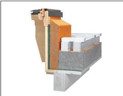
Wichtig beim Herausheben der Dachfenster ist auch hier, dass die Dampfbremse, die Wärmedämmung sowie der Unterdachanschluss bis zum Fensterrahmen geführt werden. Besonderes Augenmerk muss dabei auf die Wahl einer genügend starken Wärmedämmung gelegt werden.
