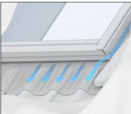
Auch wenn das VELUX Dachfenster mit dem original VELUX Eindeckrahmen und gemäss der VELUX Einbauanleitung montiert wurde, muss das Abfliessen von Dachwasser jederzeit gewährleistet werden können.
