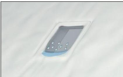
Es kann sich ein Wasserstau (kleiner Stausee) unterhalb des Dachfensters bilden. Dieses Wasser fliesst über das Unterdach weg, kann aber bei genügender Höhe (Schwellenhöhe) auch zwischen Fensterflügel und Fensterrahmen eindringen.
