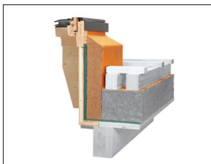
Quand on surélève une fenêtre de toit, il est également important de veiller à ce que le frein-vapeur, l'isolation thermique et le raccord de sous-toiture soient amenés jusqu'au cadre de la fenêtre. Il faut tout particulièrement faire attention à ce que l'isolation thermique soit suffisante.
