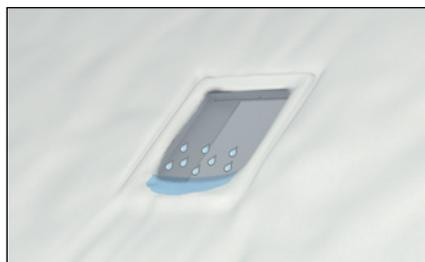
Une retenue d'eau (poche d'eau) peut se former au bas la fenêtre de toit. Cette eau est évacuée par la sous-toiture mais, si la hauteur est suffisante (hauteur du seuil), elle peut aussi entrer entre les battants et le cadre de la fenêtre.
