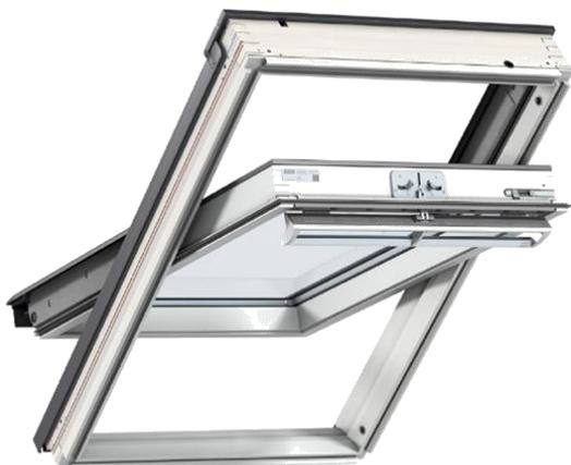
Ventana de apertura superior (pivotante) Con barra de apertura y ventilación superior. Cuenta con filtro para evitar la entrada de polvo e insectos. El nuevo diseño ergonómico de la aleta facilita su uso. Producto de operación manual y opción a ser motorizado. Hoja de ventana gira en 180° para limpieza. Superficie de marco libre de mantenimiento. Marco de pino nórdico bañado en poliuretano blanco. Garantía 10 años.
