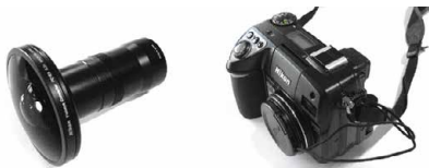
Obrázek 1.31: Fotoaparát Nikon CoolPix a širokoúhlý objektiv („rybí oko“) používaný pro vytváření map jasu.
