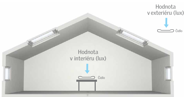
Obrázek 1.35: Výkres ukazující naměřené hodnoty koeficientu denního osvětlení (současné měření úrovně vnitřní a venkovní intenzity osvětlení [bez zastínění překážkami] na vodorovné rovině).
