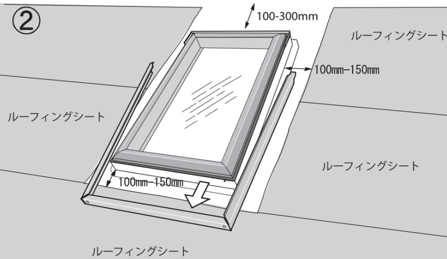
ルーフィングシートを貼ります。粘着型の防水シートと野地板の接着面を図のように確保してください。アルミ外装板を一旦外します。
