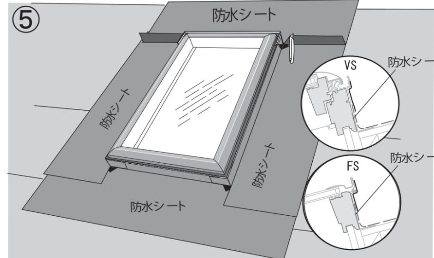
※防水シート粘着面の剥離紙には切り込みがありますので、剥がして窓の立上がり面に貼って下さい。
