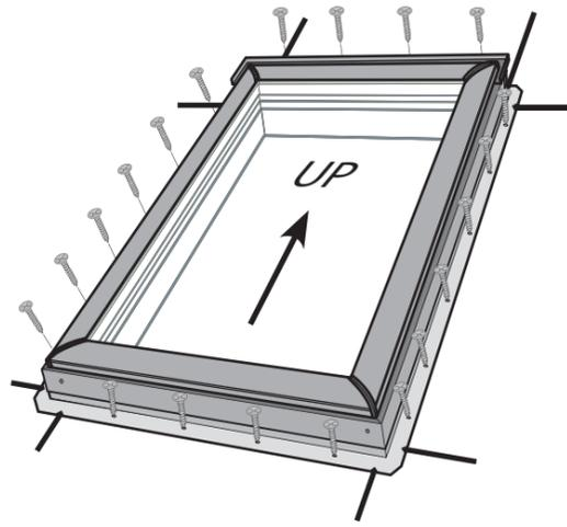
本体の上下を正しく設置し、開口の延長線と本体のキザミが合っていることを確認してください。野地への取り付けは、固定枠の丸穴全てにねじで行います。
