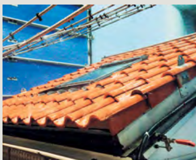
Випробування вікна VELUX в аеродинамічній трубі, де відтворюються умови зливи та буревію.
